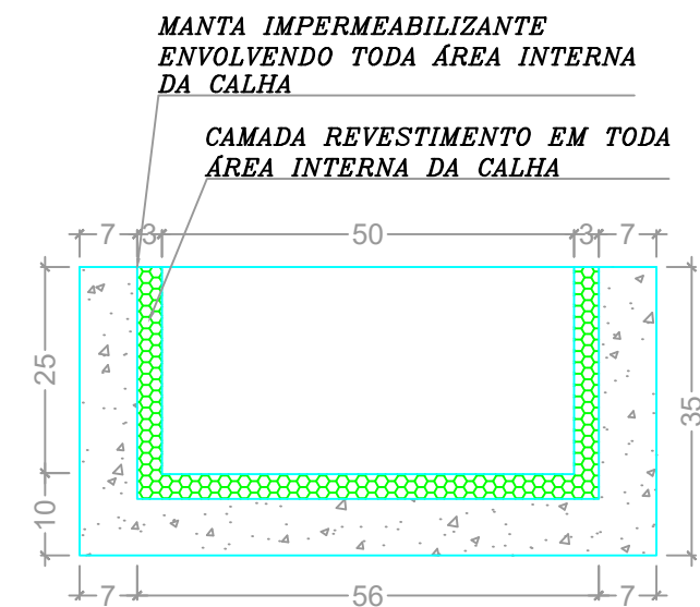
CALHA DE CONCRETO 1 COM IMPERMEABILIZAÇÃO DE MANTA ESCALA 1:10
