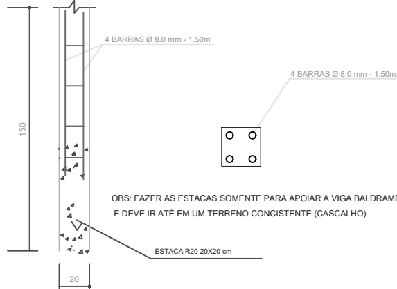
DETALHE DE ESTACA R20 - (20x20) sem/escala
